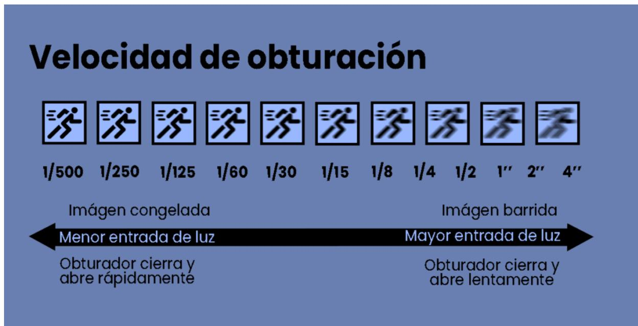
A diferencia de la apertura del diafragma, que se ubica en la LENTE, de la **velocidad de obturación** se encargará LA CÁMARA. Esta cortina se ubica delante del sensor.
